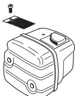
Tlumič výfuku je určen ke snížení úrovně hluku a k usměrnění výfukových plynů směrem od užívatele. Výfukové plyny jsou horké a mohou obsahovat jiskry, které by mohly způsobit požár, pokud by byly nasměrovány proti suchému a hořlavému materiálu.
