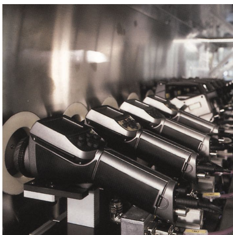
Obrázek 14.5 VLEVO: Testování IČ kamer v klimatické komoře; VPRAVO: Robot pro testování a kalibraci kamer
