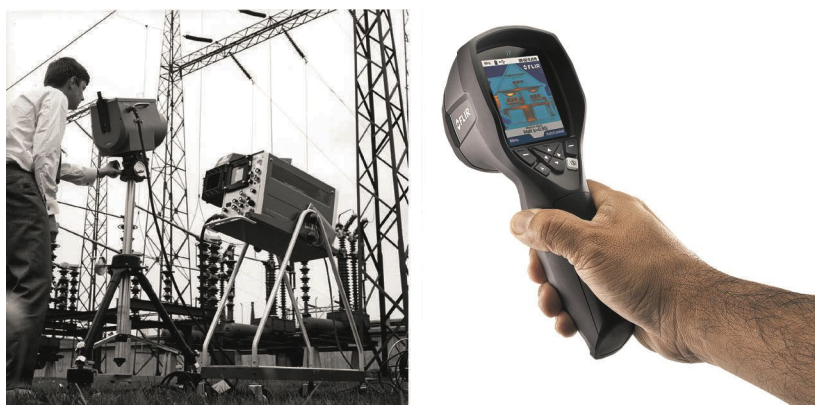
Obrázek 14.2 VLEVO: Thermovision Model 661 z roku 1969. Kamera vážila přibližně 25 kg, osciloskop 20 kg a stativ 15 kg. Operátor také potřeboval generátor 220 VAC a 10litrovou nádobu s tekutým dusíkem. Vlevo od osciloskopu je vidět připojený Polaroid (6 kg). VPRAVO: Flir i7 z roku 2012. Hmotnost: 0,34 kg, včetně baterie.
