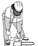
**FIGYELEM!** Ne húzza ki az indítózsinórt teljesen, és ne engedje el az indítófogantyút, ha a zsinór teljesen kihúzott állapotban van. Ez a gép károsodását okozhatja.
