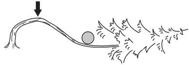
Döntse el, hogy melyik a feszültség alól való feloldás legbiztosabb módja, és hogy Ön ezt meg tudja-e biztonságosan oldani. A különösen bonyolult esetekben a legbiztosabb módszer a motorfűrész félretenni és inkább csőrőt használni.
