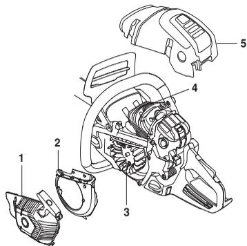
Očistite chladiaci systém raz do týždňa kefkou, príp. pri náročnejších podmienkach častejšie. Špinavý alebo zablokovaný chladiaci systém má za následok prehriatie stroja, ktoré spôsobuje poškodenie piestu a valca.
