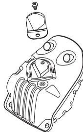
Tlumič výfuku je určen ke snížení úrovně hluku a k usměrnění výfukových plynů směrem od uživatele. Výfukové plyny jsou horké a mohou obsahovat jiskry, které by mohly způsobit požár, pokud by byly nasměrovány proti suchému a hořlavému materiálu.
