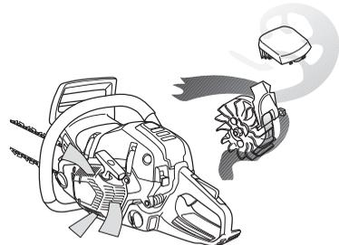
**UPOZORNĚNÍ!** Aby se zachovala správná funkce odstředivého čistícího systému, je nutno pravidelně provádět jeho údržbu. Tato údržba spočívá v čištění sání vzduchu do startéru, lopatek ventilátoru, prostoru kolem oběžného kola ventilátoru, vstupního potrubí a komory karburátoru.
