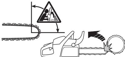
Řezání spodní stranou lišty, tzn. shora dolů, se označuje jako řezání nabíhacím řetězem. V tomto případě řetěz přitahuje pilu směrem ke stromu a přední část těla pily se při řezání bezprostředně opírá o kmen. Řezání nabíhacím řetězem poskytuje uživateli lepší kontrolu nad motorovou pilou a polohou oblasti zpětného rázu.
