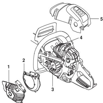
Elementy układu chłodzenia należy czyścić szczotką raz w tygodniu, lub gdy zachodzi potrzeba – częściej. Zanieczyszczony lub zatkany układ chłodzenia powoduje przegrzanie silnika maszyny, w konsekwencji czego następuje uszkodzenie cylindra i tłoka.
