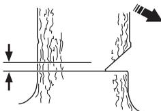
Illessze be a kéregtámaszt (ha fel van szerelve) a törési léc mögé. Hatoljon a vágószerszeggel óvatosan a fatörzsbe, teljes gázadás mellett. Győződjön meg arról, hogy a fa nem kezd el a tervezett irányval ellentétes irányba mozdulni. Helyezzen a vágásba döntőkeket vagy döntőemelőt, amint a vágás elég mély.
