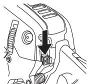
**FIGYELEM!** Az indítás/leállítás kapcsoló automatikusan visszatér a működési helyzetbe. A szándékatlan elindítás megelőzése érdekében szereléskor, ellenőrzés és/vagy karbantartás végzésekor a gyertyasapkát el kell távolítani a gyújtógyertyáról.
