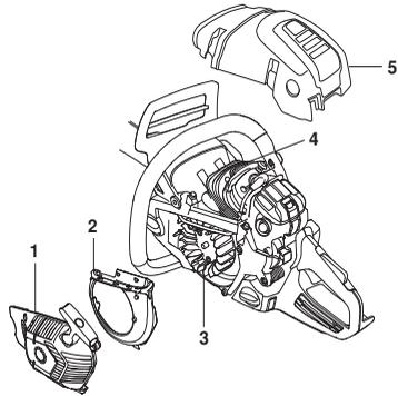
Chladicí systém je zapotřebí čistit kartáčem jednou za týden, v případě náročných podmínek ještě častěji. Znečištěný nebo ucpaný chladicí systém má za následek přehřívání zařízení, což vede k poškození válce a pístu.
