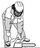
**UPOZORNĚNÍ!** Nevytahujte celou délku lanka startéru, nepouštějte startovací madlo a nenechávejte plně vytažené lanko samovolně navíjet. To by mohlo stroj poškodit.
