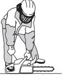
**UWAGA!** Nie wyciągaj linki rozrusznika całkowicie i nie puszczaj jej nagle, gdy jest wyciągnięta. Może to spowodować uszkodzenie maszyny.
