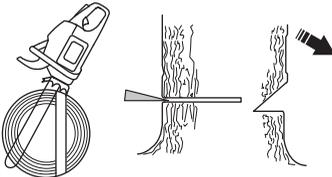
Skončíte hlavný rez vedený súbežne s klinovým rezom tak, aby medzi nimi ostala vzdialenosť minimálne 1/10 priemeru kmeňa. Neprerezaná časť kmeňa medzi hlavným rezom a klinom sa nazýva nedorez.
