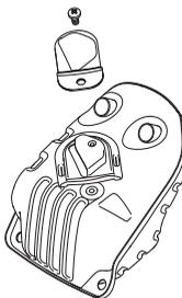
**FIGYELEM!** A hangfogó a használat során és után erősen felhevül. Ez az alapjárat esetében is így van. Legyen tudatában a tűzveszélynek, különösen ha gyúlékony anyag és/vagy gáz közelében dolgozik.
