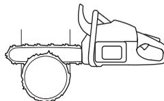
I pro kácení stromů o průměru větším než je délka lišty existují určité metody. Tyto metody však představují mnohem větší nebezpečí kontaktu oblasti zpětného rázu lišty se stromem.
