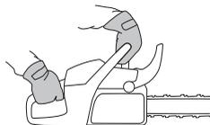
Adjon teljes gázt, és helyezze üzembe a láncfékét bal csuklója előrehajlításával, anélkül, hogy a fogantyút elengedné. **A láncnak azonnal meg kell állnia.**
