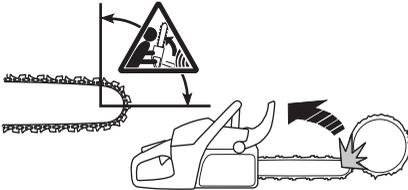
Odbicie powstaje zawsze w płaszczyźnie tnącej prowadnicy. Zazwyczaj pilarka i prowadnica zostają odrzucone do tyłu i do góry, w kierunku operatora. Pilarka może zostać odrzucona w kierunku zależnym od swego położenia w momencie, gdy strefa odbicia natrafia na twardy przedmiot.
