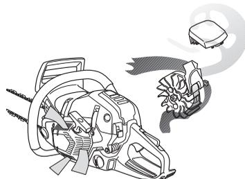
**FONTOS!** A centrifugális tisztítás működőképességének megőrzéséhez folyamatos karbantartásra és tisztításra van szükség. Tisztítsa meg az indítókészülék levegőnyílásait, a lendkerék ventilátorlemezait, a lendkerék környékét, a beszívócsatornát és a porlasztótérét.
