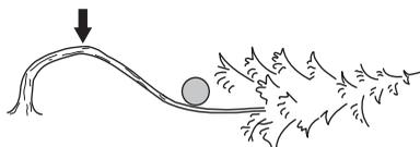
Premyslite si najbezpečnejší spôsob uvoľnenia pnutia a zvážte, či to dokážete bezpečne urobiť. V komplikovaných prípadoch je jedinou bezpečnou metódou odložiť reťazovú pílu a použiť navijak.
