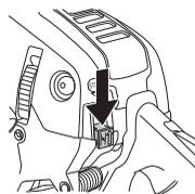
**UPOZORNĚNÍ!** Spínač spuštění/zastavení se automaticky vrátí do polohy běhu. Abyste zabránili nechtěnému spuštění, musí být koncovka kabelu zapalovací svíčky ze zapalovací svíčky vždy odstraněna, když je stroj bez dozoru.
