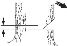
Ustaw zderzak (jeżeli takowy jest zamontowany) tuż za zawiasą. Podczas ścinki pilarka powinna pracować przy całkowicie otwartej przepustnicy. Powoli wprowadzaj łańcuch/prowadnicę w drzewo. Upewnij się, czy drzewo nie przechyliło się w kierunku przeciwnym do zamierzonego kierunku obalania. W odpowiednio głęboki rząz włóż klin lub dźwignię-obracak.
