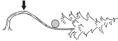
Określ najbardziej bezpieczny sposób zwolnienia naprężenia i oceń czy jesteś w stanie to wykonać. W bardzo skomplikowanych sytuacjach najbezpieczniej jest zrezygnować z pracy pilarką i użyć wciągarki.
